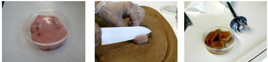
Über Nah-Infrarot-Reflektions-Spektroskopie wird der intramuskuläre Fettgehalt bestimmt. Es muss jedoch ein ständiger Abgleich über nasschemische Untersuchungen erfolgen, um die Eichkurven zu überprüfen.
