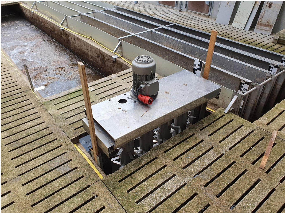
Abb. 3: Erprobung unterschiedlicher Entmistungsmethoden (mobiles Entmistungsmodul, Schleusen) im Pilotmaßstab
